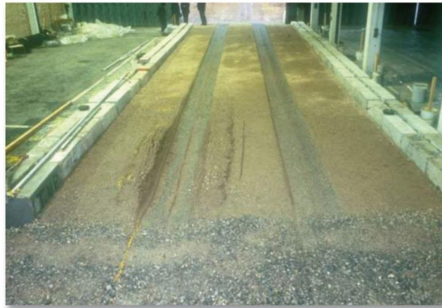
Figure 6. Zone test après les 800 passages de la roue lestée
