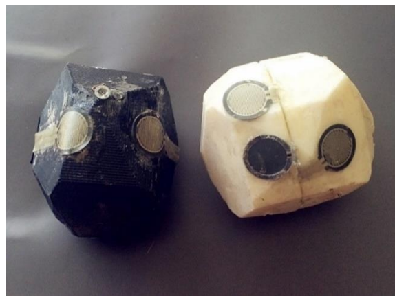
Figure 10. Morceau de ballast artificiel équipé de capteurs de mesure de déplacements et rotations.
