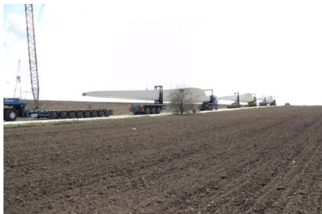
Figure 13. Piste pour le transport des fortes charges des ailes d'éoliennes. Solution de base envisagée :
